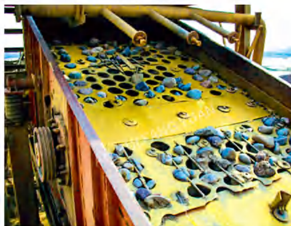
钢制筛网使用效果 The Application of Steel Screen Panel
